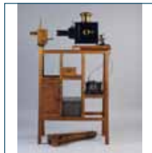
Appareil de prise de vue et de projection, lanterne de projection, rhéostat du «Cinématographe» d'Auguste et Louis Lumière, 1897
