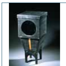
Boîte à mercure pliante pour développer la plaque de cuivre argentée dans le procédé de daguerréotypie. Inv. 09553-5
