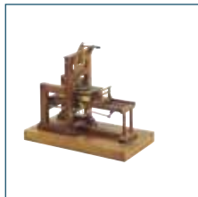
Presse d'imprimerie à excentrique et à levier construite sur un modèle présenté à Louis XVI, 1784. Inv. 00469
