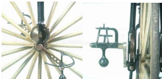
Pédale à contrepoids muni de cale-pieds du vélocipède d'Ader
