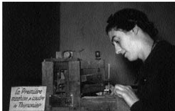
Présentation de la première machine à coudre de Thimmonier. Notez le bâti en bois.
