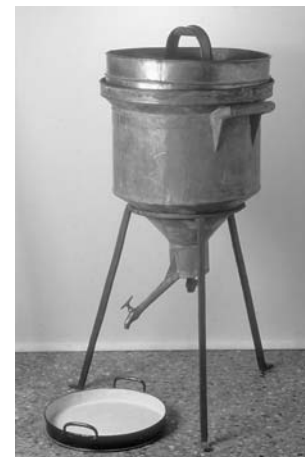
Calorimètre original de Lavoisier, vers 1780, inv. 752.
