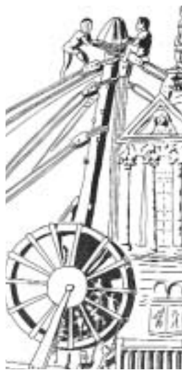
Engin de levage romain pour la construction du tombeau des Haterii. Des « servants » grimpent dans la cage, une grande roue de bois ajourée. Ils la font tourner en grimpant tous du même côté. Celle-ci en tournant enroule ou déroule la corde de levage permettant de monter ou descendre la charge à mouvoir.
