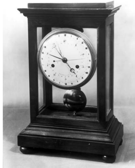
Horloge révolutionnaire de Le Paute. Sur le cadran on peut lire un double affichage : en chiffres arabes, les 10 heures révolutionnaires et, en chiffres romains, les 24 heures habituelles. 1775-1800, inv. 14568.
