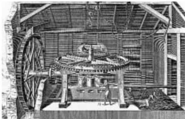
Engrenage ancien en bois dans un moulin à eau.
