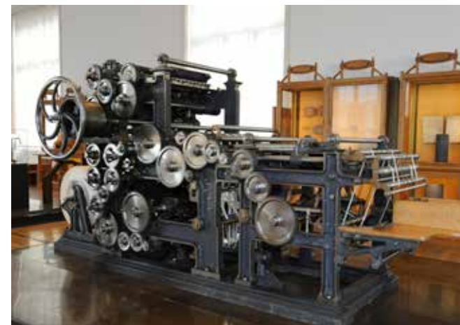
Presse typographique rotative à pleuse système Marinoni, 1880-1886. © Musée des arts et métiers-Cnam/photo Michèle Favareille
